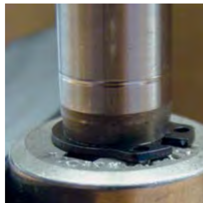
Изношенный вал с проточкой/ Worn shaft with groove
