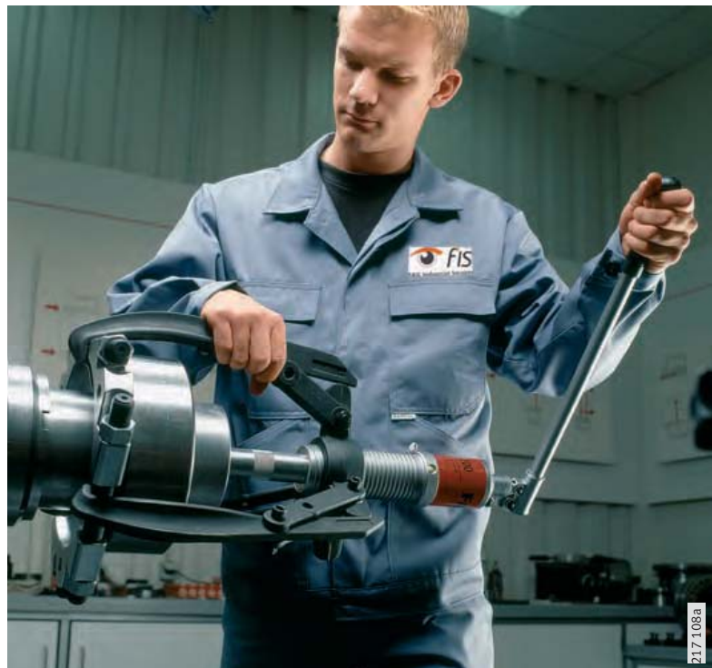
Рисунок 1 Демонтаж подшипника с помощью гидравлического съемника
