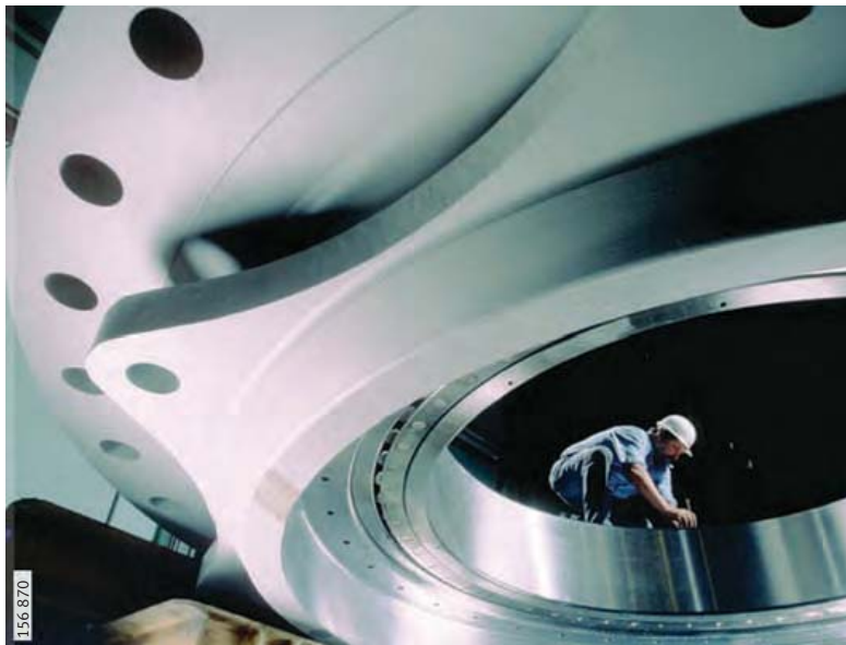
Рисунок 5 Монтаж крупногабаритного подшипника качения
